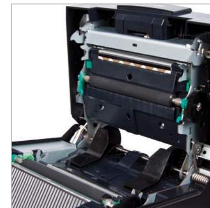
DB-EA4D incorpora fácil acceso al recorrido del papel, mantenimiento sin herramientas y 2 cabezales para imprimir simultáneamente en las caras delantera y trasera del papel térmico.
